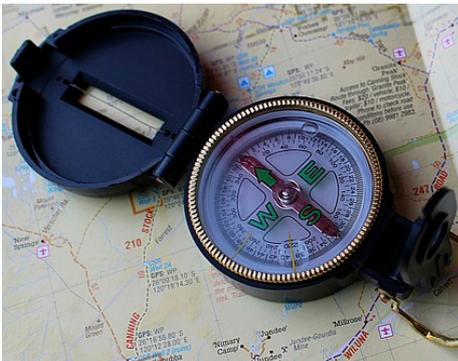
Ab dem 13. Jahrhundert wurde der **„trockene Kompass“** verwendet, da dieser genauer war als sein Vorgänger. In einem Gehäuse ist eine drehbare Magnetnadel verbaut. Die Magnetnadel dient als Zeiger und besteht aus einem **ferromagnetischen Stoff, der magnetisiert** wurde. Diese Magnetnadel richtet sich näherungsweise in Nord-Süd-Richtung aus. Um das Ablesen der Himmelsrichtung zu vereinfachen, ist im Kompass auch eine Windrose oder eine Winkelskala angebracht.
